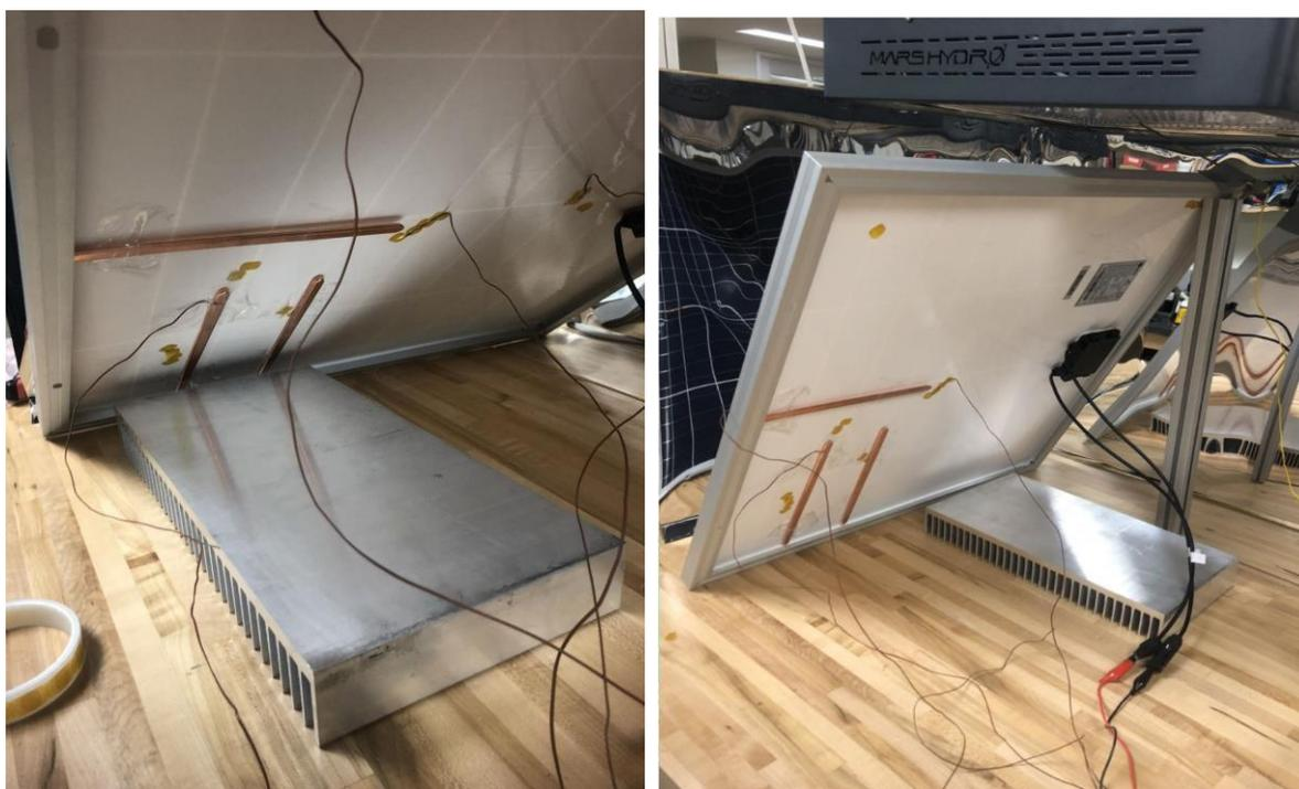
**Рисунок 8. Установки для тестирования тепловых труб и радиаторов.**
