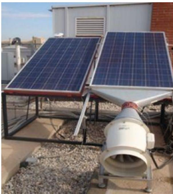
**Рисунок 2. Принудительное воздушное охлаждение.**
