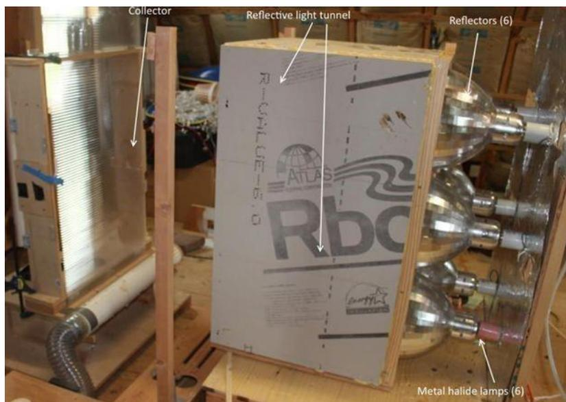
**Рисунок 6. Пример солнечного симулятора DIY.**
