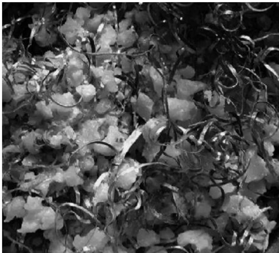
**Рисунок 5. PCM и алюминиевые ребра, используемое для охлаждения фотоэлектрической системы.**
