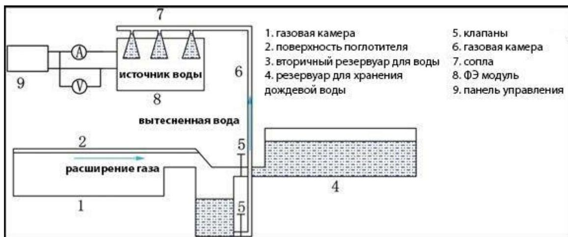
**Рисунок 3. Пассивная система охлаждения дождевой водой для бытовых домов.**
