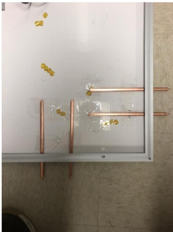
**Рисунок 9. Улучшенная настройка тестирования тепловых труб.**
