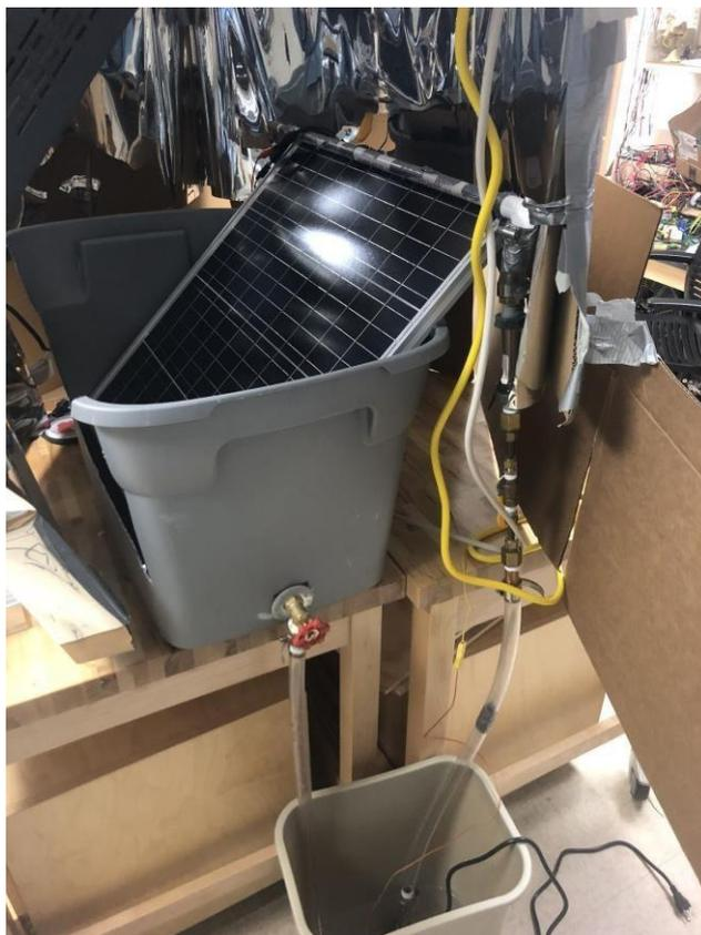
**Рисунок 10. Испытательная установка водяного охлаждения.**
