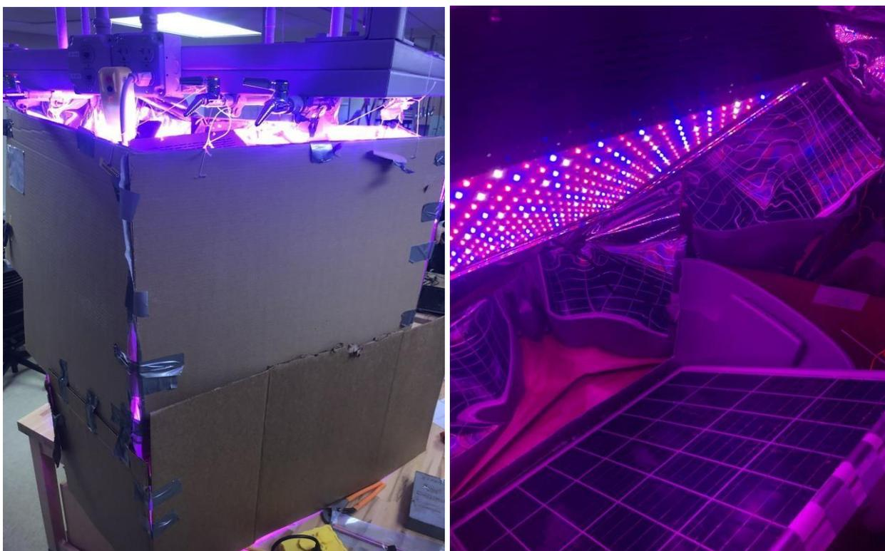
Рисунок 7. Используемый солнечный симулятор.
