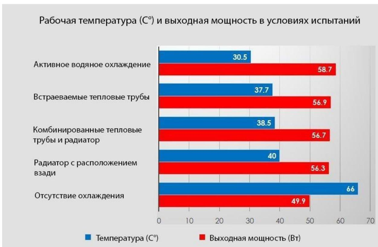
**Рисунок 11. Температура и выходная мощность для каждого проверенного метода охлаждения.**
